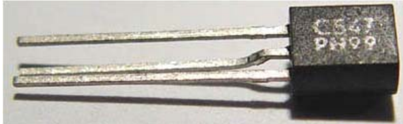
Transistor T1 : BC547
